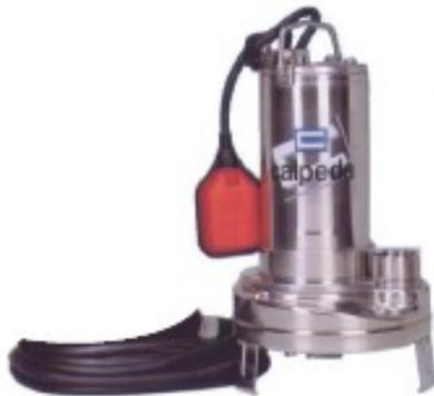
Pompe monogiranti sommergibili in acciaio inossidabile al nichel-cromo, con bocca di mandata verticale, con girante arretrata (a vortice), doppia tenuta sull'albero con camera d'olio interposta.
